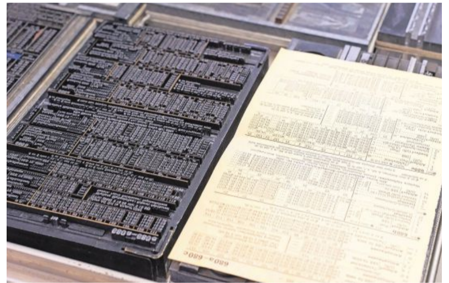
Bleisatz, mit dem die Seite aus dem SBB-Kursbuch, gleich daneben, gedruckt wurde.
